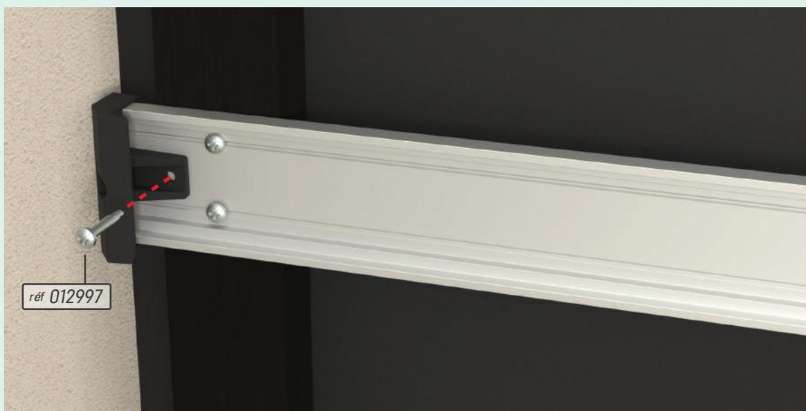
**!** Assurez-vous que les clips de bordure sont correctement alignés sur tous les profilés Linup pour garantir une fixation optimale et un rendu final uniforme. Utilisez un laser pour aligner les clips de bordure verticalement ou horizontalement, selon le type de pose.
