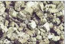
La **vermiculite** est un minerai naturel proche de la famille des micas. Avant traitement, elle est triée, calibrée et tamisée. Le traitement thermique (exfoliation au gaz naturel) à 900° C aboutit au
