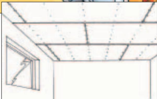
Les plaques de plâtre Knauf de 9,5 mm d'épaisseur sont posées perpendiculairement aux profilés porteurs. Veiller à ce que les joints d'about soient alternés. Visser les plaques tous les 15 cm à 1 cm minimum des bords.
