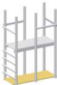
PLANCHER DE SOL GRONDVLOER 2 x Ref 12-1355-15A 2 x 100 x 79 cm
