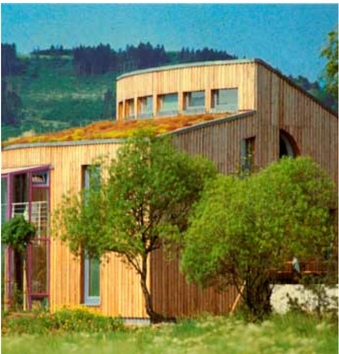
Maison double: toit vert avec 30 cm d'isolation; murs en briques de grand format avec 16 cm d'isolation + panneau de protection de l'isolation Celit 3D
