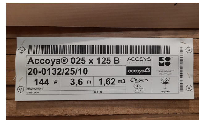
3.4 ÉTIQUETTES DE BOTTE D'ACCOYA COMPRENANT LA DIMENSION, LA QUALITÉ, LA LONGUEUR, LA QUANTITÉ ET LE NUMÉRO DE LOT
