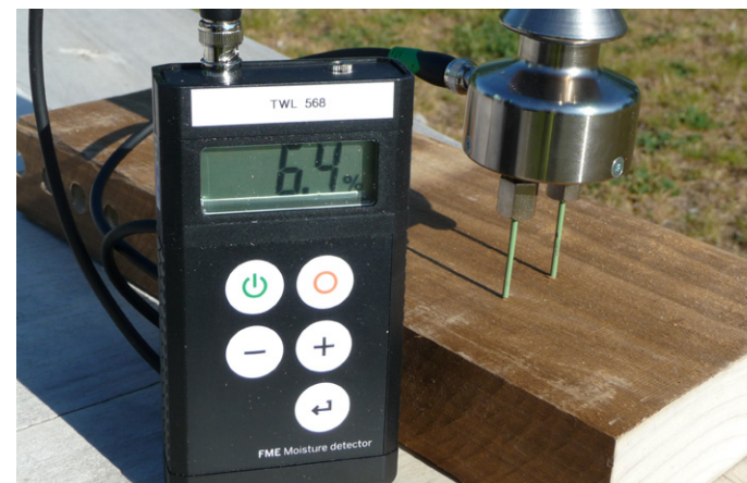
ANALYSEUR D'HUMINITÉ (PIN METER)
