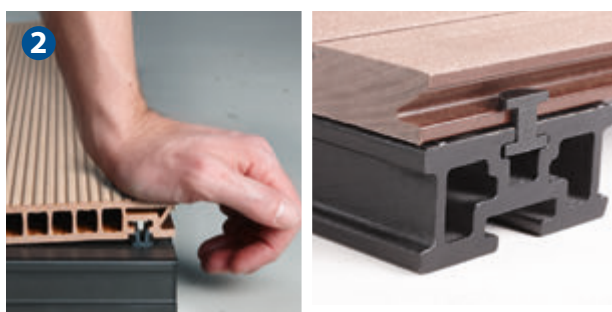
Visser le premier clip sur le support et encliqueter la première lame.
