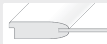
Rahmentürkonstruktion mit eingesetzten Füllungen, Rahmenfrieze aus MDF
