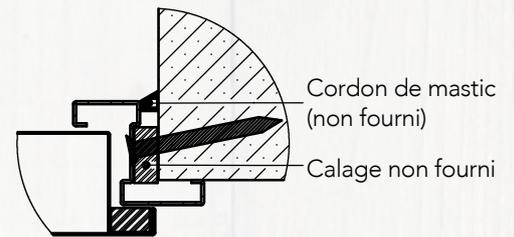
3 chevilles mécaniques à expansion diamètre 8mm par montant et 2x3 en traverse (Non fournies)
