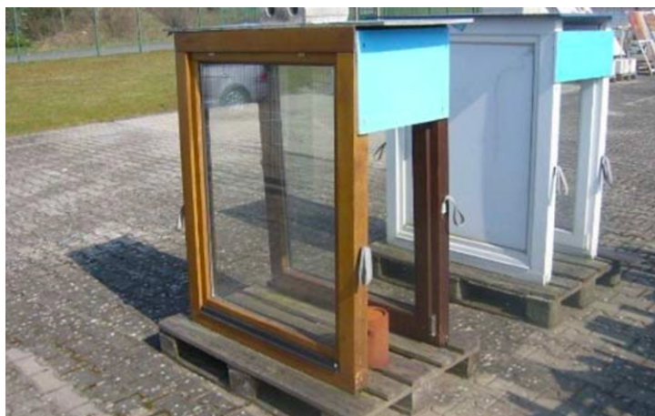
Les bancs d'essai après 10 ans d'exposition
