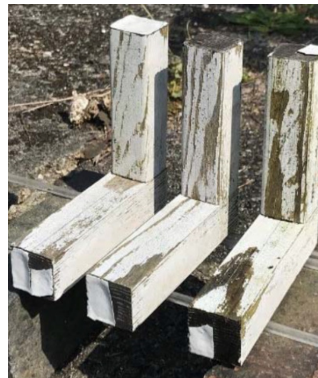
Les joints en L acétylés après 20 ans d'exposition
