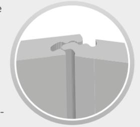
Unsere Hydrolock®-Verbindung ist präzise konstruiert und bildet eine diskrete, wasserdichte Fuge, ohne den Einsatz von Profilen. Die Hydrolock®-Verbindung kann sogar an unebenen Wandflächen angebracht werden.
