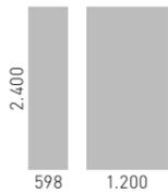
Für eine einfachere Installation können Paneele in verschiedenen Breiten bezogen werden:
